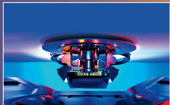
JOST bietet seinen Kunden intelligente Systeme für Nutzfahrzeuge, wie dieses innovative Komfort-Kupplungs-System (KKS), das den kompletten Kupplungsvorgang durch eine selbsttätige Steckverbindung mit Fernbedienung automatisiert – ein entscheidender Beitrag zum autonomen Fahren.
